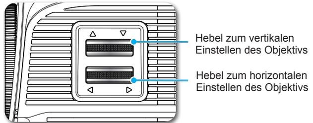
PureShift bietet eine Funktion zum Einstellen des Objektivs, die dem horizontalen oder vertikalen Anpassen der Position des projizierten Bildes innerhalb eines nachstehend beschriebenen Bereichs dient. PureShift ist ein einzigartiges System, mit dem Sie das Objektiv einstellen können, wobei ein deutlich höheres ANSI-Kontrastverhältnis als bei üblichen ObjektivEinstellsystemen erreicht wird.
